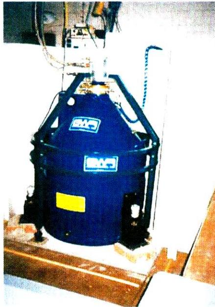
**figure 12 : Gravimètre supraconducteur de l'observatoire gravimétrique de Strasbourg**
